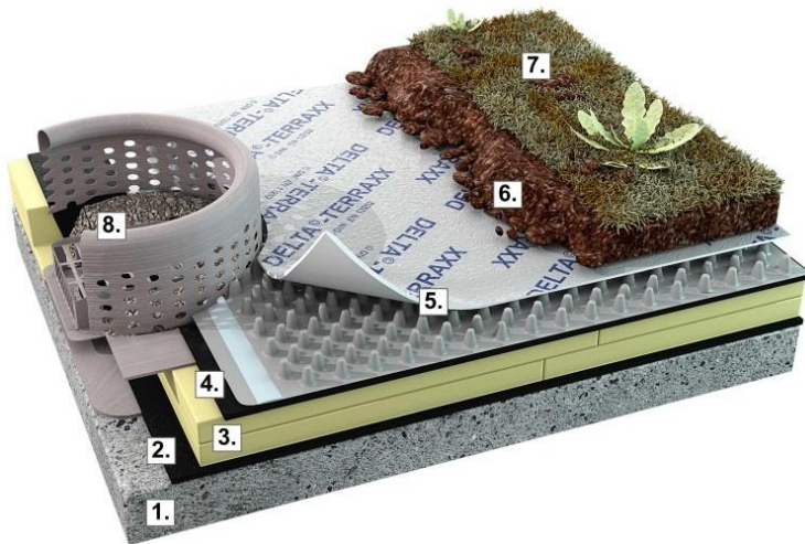
Figure 6 - Schéma de principe nappe drainante (DELTA®-NP DRAIN ou DELTA®-TERRAXX)
