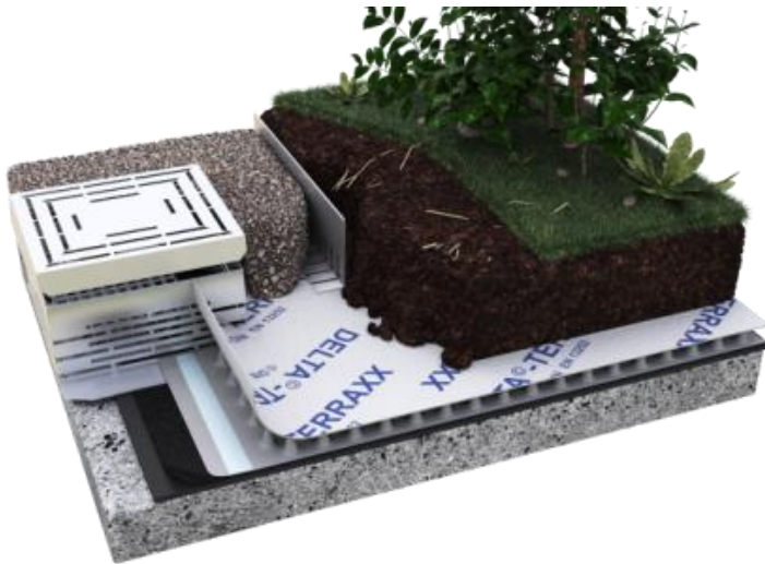
Figure 5 - Schéma de principe nappe drainante et de rétention d'eau (DELTA®-FLORAXX TOP)
