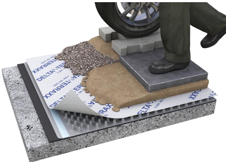
Figure 11 - Schéma de principe nappe de protection et drainage (DELTA®-TERRAXX / DELTA®-TERRAXX TP)
