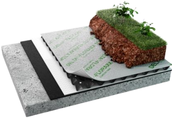
Figure 7 - Schéma de principe nappe drainante et de rétention d'eau (DELTA®-FLORAXX TOP)
