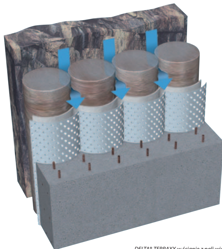
DELTA®-TERRAXX w ścianie z pali wierconych.
